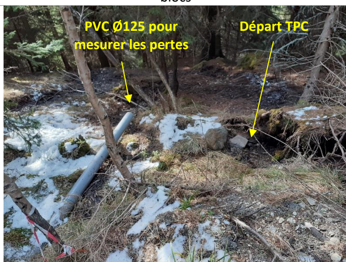
Pertes en eau de la tranchée, côté amont
