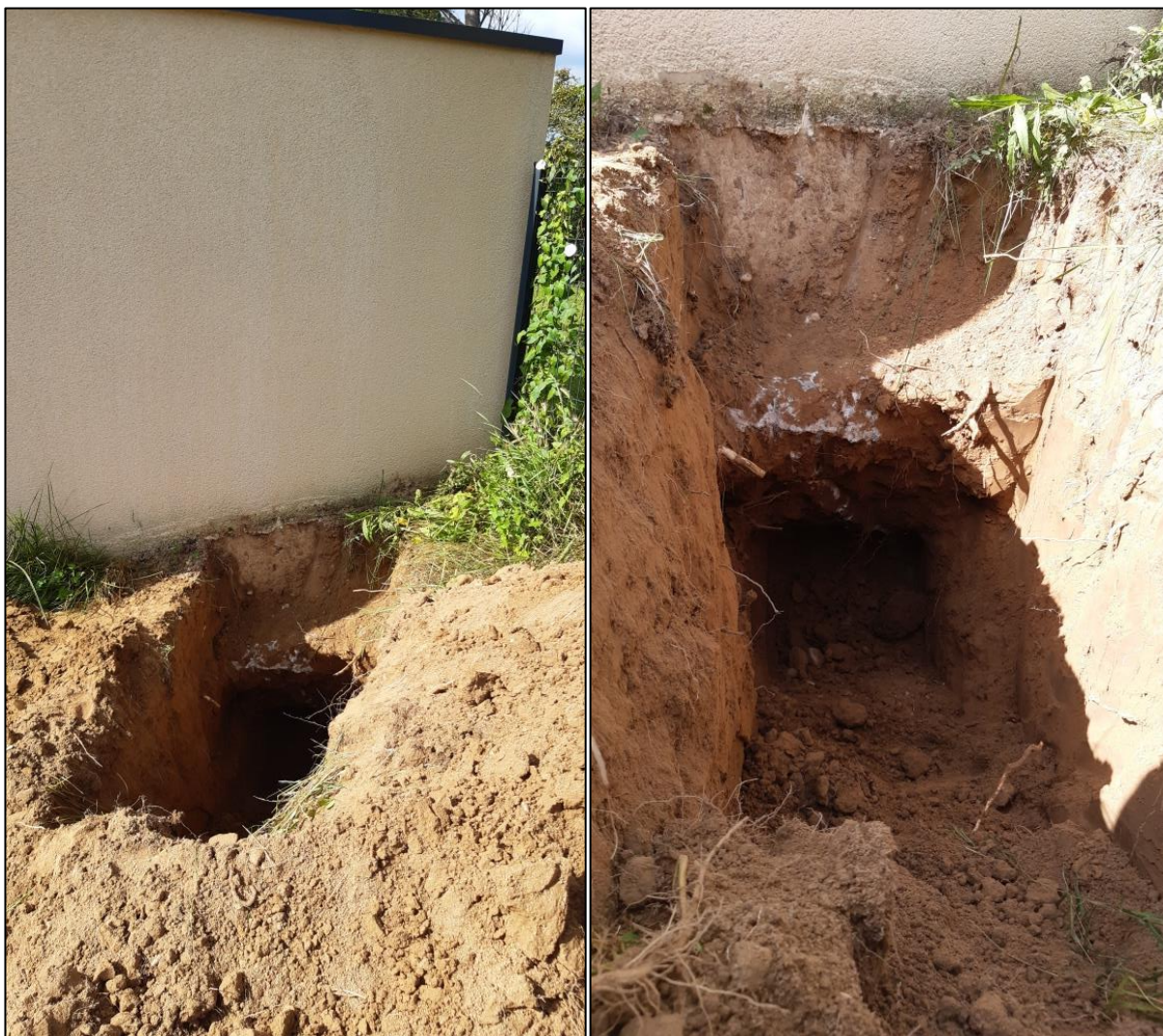
Figure 11 : Photographies du sondage de reconnaissance de fondation RF2 (ALIOS 02/07/2024).
