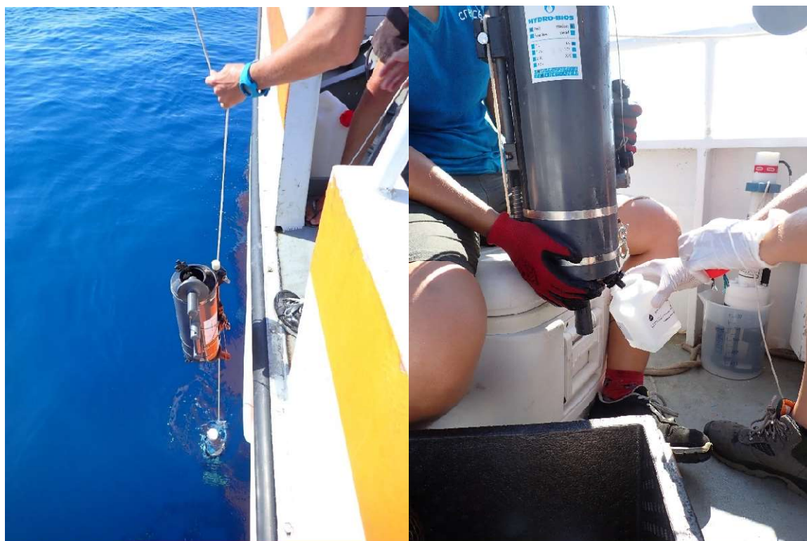
Figure 9 : Illustration du déploiement de la bouteille NISKIN ouverte (à gauche) et remplissage des flacons (à droite)
