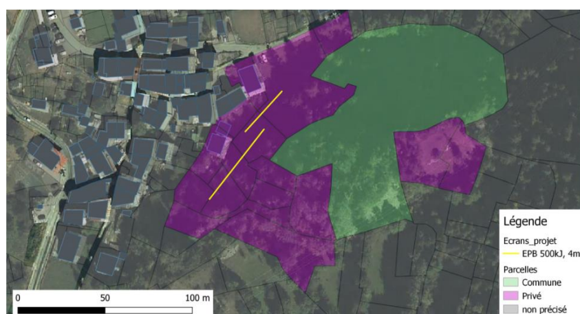
Figure 2 : Installation d'écrans pare blocs 500 kJ / 4m de hauteur à la Masure
